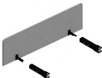
Panel górny do biurka i biurka z sideboardem CS5040 – montaż z uchwytami bazowymi (model 1)
